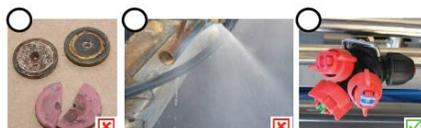
Comprobaremos con una jarra graduada que el caudal de cada una de las boquillas no se desvíe más del 10% del caudal nominal indicado en la tabla del fabricante.
