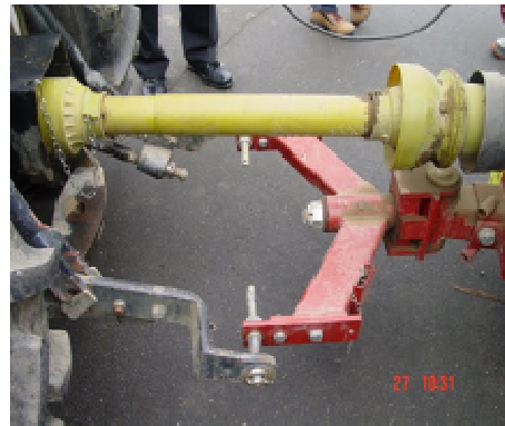
No existe la cadena de fijación en el árbol de la máquina.
