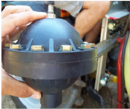
Presencia y presión correcta de los compensadores de presión (calderín).
