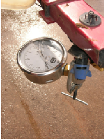
Manómetros para la comprobación del equilibrio de presiones entre los diferentes sectores de la barra.
