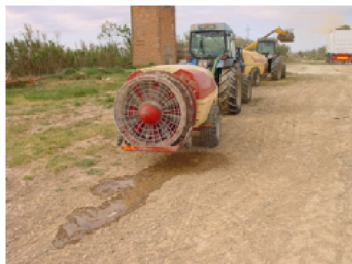
Cierre deficiente de la tapa del depósito.
