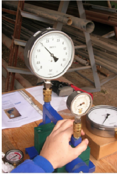
Desmontando el manómetro de la máquina y realizando la contrastación.
