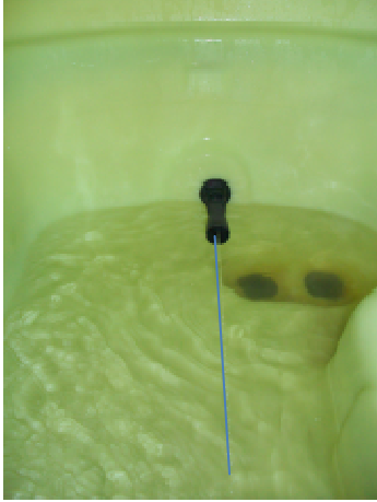
Agitación correcta en todo el depósito a régimen nominal de la TDF.
