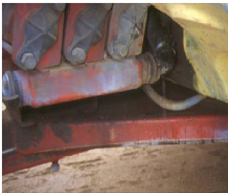
Se detectan fugas en la bomba estando ésta parada o bien en funcionamiento.
