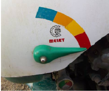
Indicador de nivel correcto y visible desde el punto de conducción y desde el punto de llenado.
