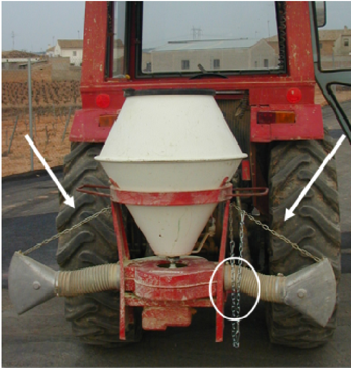
Cadenas para la unión de las partes metálicas del equipo. Cadenilla de arrastre.
