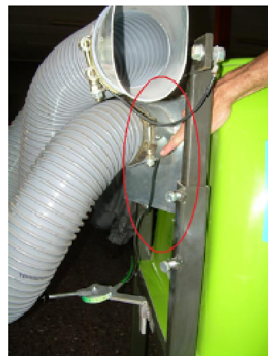
Partes metálicas del equipo conectadas entre si.
