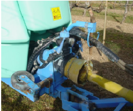
Toma de fuerza, protección y cadena de sujeción correcta.
