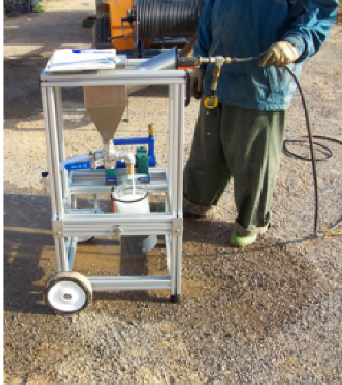
Recogida del líquido de una pistola de pulverización con una probeta graduada.
