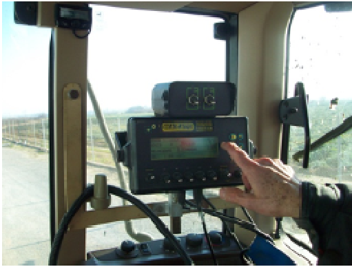
Situación adecuada de los mandos del pulverizador.
