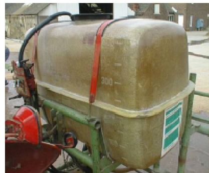
Estado del indicador del nivel tal que impide conocer la cantidad de líquido en el depósito.
