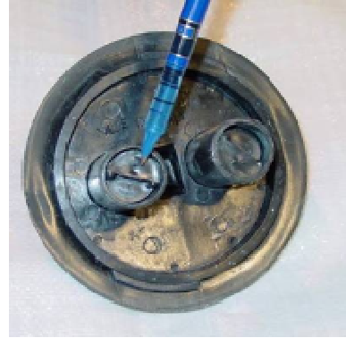
Sistema de compensación de presión en buen estado y con funcionamiento adecuado.
