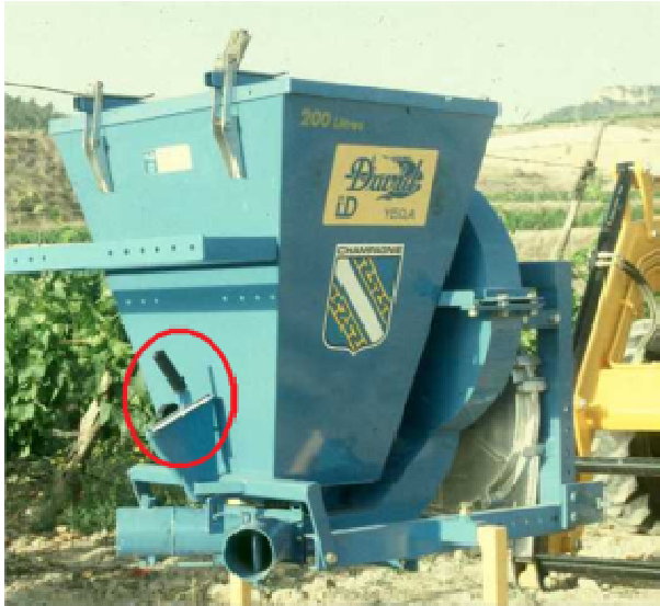
Movimiento de la palanca y correspondencia con la compuerta de salida.
