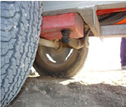
Sistema de vaciado de accionamiento difícil.
