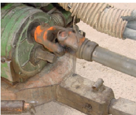
No existe la cadena de fijación en el árbol de la máquina.
